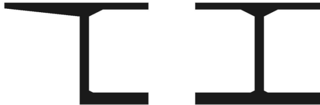
Figura 10. Sección de las barras longitudinales.
